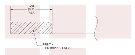
PRE-TIN CABLE JACKET TO THE REFERENCE LENGTH AS SHOWN. ONLY FOR COPPER OUTER CONDUCTOR CABLE.
